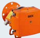
L'analizzatore di gas in situ GM35 misura simultaneamente i valori di CO<sub>2</sub> e CO o N<sub>2</sub>O. L'unità emettitore - ricevitore e il riflettore si trovano installati contrapposti sul camino. Il raggio luminoso attraversa due volte l'intero diametro del camino per aumentare l'accuratezza. Sono integrate funzioni di autoverifica e di controllo delle prestazioni.
