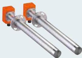
Misuratore di portata volumetrica FLOWSIC100: trasduttori a ultrasuoni estremamente precisi e robusti in titanio garantiscono una lunga durata e affidabilità di misura. Per raggiungere il target di incertezza è possibile scegliere una misura su un percorso o più percorsi. Integra un sistema automatico che verifica ciclicamente lo zero e lo span per mantenere sotto controllo la qualità della misura.
