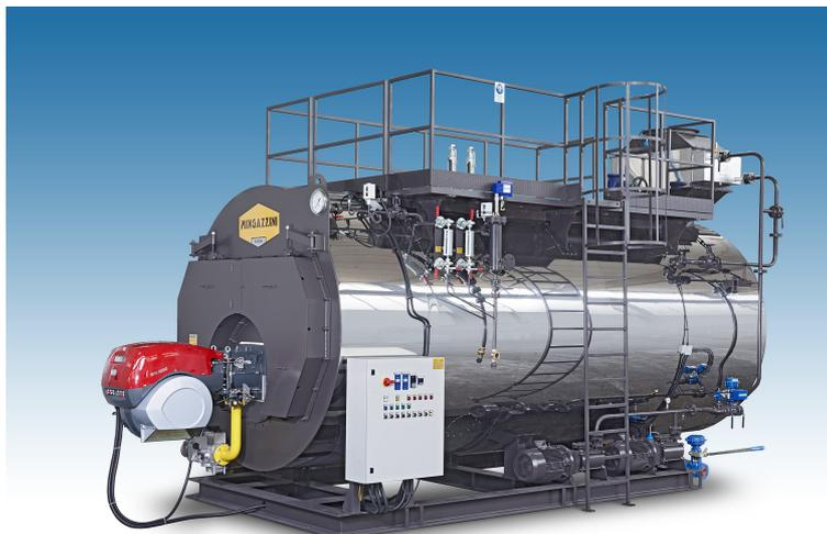
Infine, si possono ottenere risultati ancora maggiori, utilizzando un sistema di recupero energetico della serie “ARS –Advanced Recovery System”, studiato sempre su misura per il cliente, con rendimenti anche fino al 99%, spingendo all’estremo la condensazione dei fumi di caldaia per recuperare quanto più possibile del calore latente in essi contenuto (oltre chiaramente a quello sensibile).
